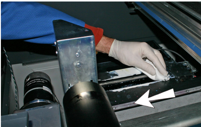
Рисунок 10-10 Очистка верха станции обслуживания
