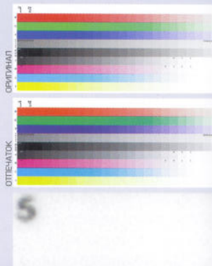
Фрагмент градиентной заливки 2-процентной плотности. Вид печатных капель при увеличении 8x
