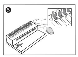
Используя ручку разжима пружины, разожмите пружину.
