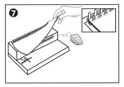
Снимите готовую брошюру с переплётного механизма.
