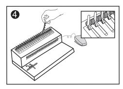
Поместите пластиковую пружину за держатель переплетного механизма зубцами вверх.
